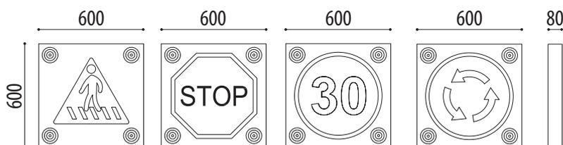
Señal fabricada en hierro galvanizado formada por cajón cerrado resistente a la intemperie. Se monta sobre un poste redondo y se fija al mismo mediante dos abrazaderas.
