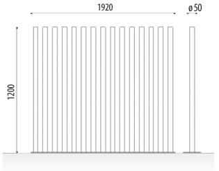
**Valla metálica modelo Parc-Dog** construida a partir de barrotes de 1200 mm. de altura y tubo redondo de ø 50 mm. de diámetro, soldados sobre pletina de 150x10 mm. para fijar mediante varillas o tornillería.
