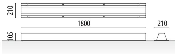
**Tope de ruedas de hierro modelo Sepang** fabricado con chapa de acero galvanizado, plegada en forma de "U" invertida, con laterales planos para fijar a suelo mediante tacos metálicos.
