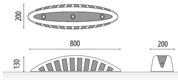
**Separador carril bici modelo Snake** fabricado con material reciclado en 1 sola pieza de medidas 800x200x130 mm. Color negro y pintura con microesfera reflectante color blanco.
