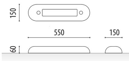
**Separador vial de caucho macizo modelo Sevi** de un solo bloque con tiras reflectantes diseñado para separar los carriles (bus, bicicletas, ...). Gracias a estos separadores se consigue una distancia efectiva entre un carril y los carriles adyacentes en una vía de circulación de tráfico.
