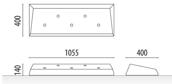
**Separador vial de caucho modelo Smart** fabricado con granulado de caucho reciclado de color negro reforzado con poliuretano.
