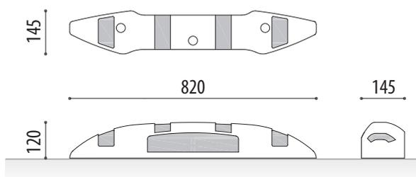
**Separador vial modelo Pitón** fabricado con **material reciclado** en 1 sola pieza de medidas 820x145x120 mm. Color negro y pintura con microesfera reflectante color blanco.
