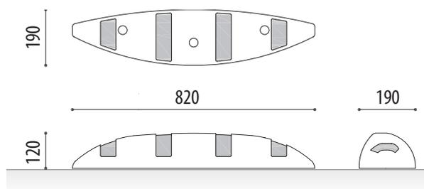
**Separador vial modelo Pantera** fabricado con **material reciclado** en 1 sola pieza de medidas 820x190x120 mm. Color negro y pintura con microesfera reflectante color blanco.
