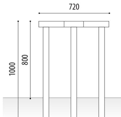
**Protector para árboles y farolas modelo Roble con tubo de hierro galvanizado en caliente de forma circular y con 3 pies de sujeción.**
