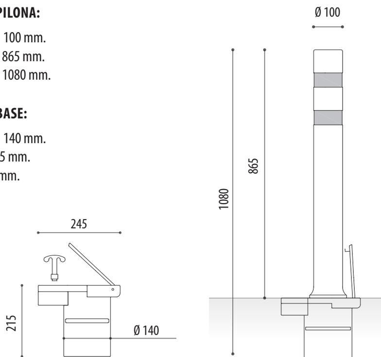
Las pilonas semiflexibles A-ECO están fabricadas con un material plástico que otorgan una **flexibilidad limitada**, en caso de impacto y no vencer su flexibilidad, vuelven a su posición sin deformación alguna. En caso de vencer estos grados, vuelven a su posición con posible deformación en su aspecto. No se rompen como el plástico convencional, hierro o fundición, convirtiéndolas así en una solución muy económica y duradera.
