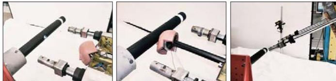
2. Certificado Applus IDIADA prueba de impacto pila A-Eco sobre torso (AIS).
