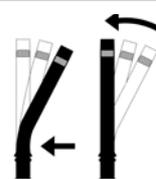
En caso de impacto, si no se sobrepasa su punto de flexibilidad máxima, estas vuelven a su posición original sin deformación alguna. En caso de vencer esta flexibilidad máxima no se rompen como el plástico convencional, hierro o fundición, convirtiéndola así en una solución muy económica y duradera.
