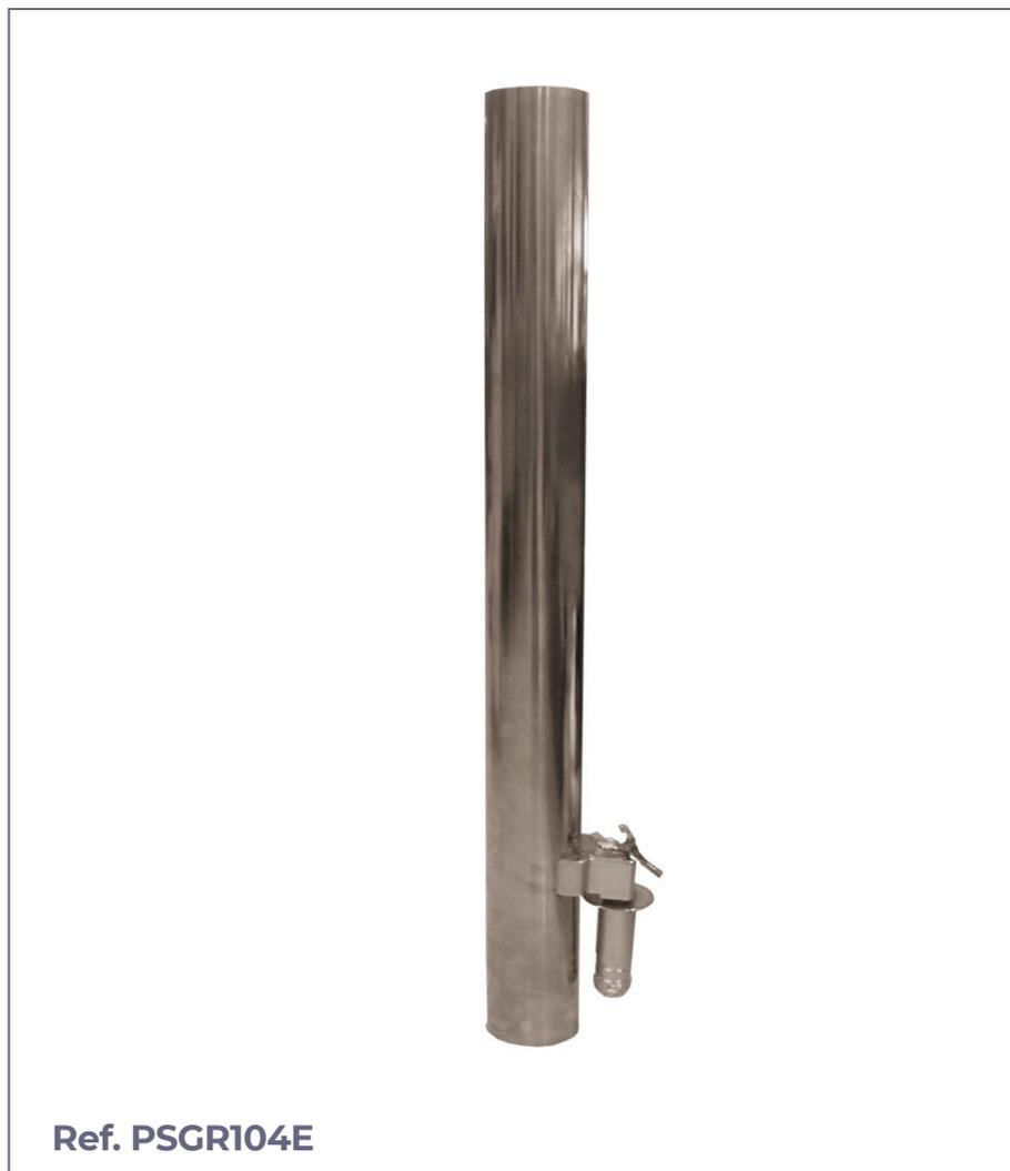
**Pilona extraíble de seguridad antialunizaje de acero inoxidable** construida con tubo de acero inoxidable de  $\varnothing$  104 mm. de diámetro. Tubo de hierro en su interior de 2 mm. de espesor, consiguiendo así una mayor resistencia a los impactos en casos de alunizaje.
