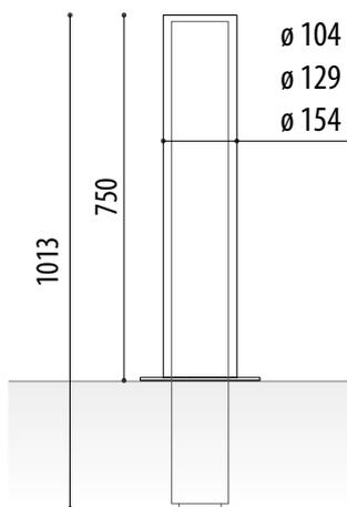
**Pilona de seguridad antialunizaje de acero inoxidable circular** construida con dos cuerpos, uno exterior de acero inoxidable y otro interior, un núcleo de hierro reforzado. Posibilidad de rellenar su interior de hormigón, arena o grava para reforzarla aún más.
