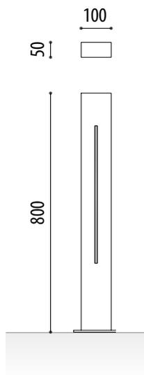
**Pilona luminosa de acero corten modelo Porto con leds** de bajo consumo, construida con tubo de acero corten de 100x50 mm.
