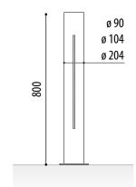
Pilona luminosa modelo Inox con leds de bajo consumo. Construida con tubo de acero inoxidable AISI 304 de 2 mm. de espesor.
