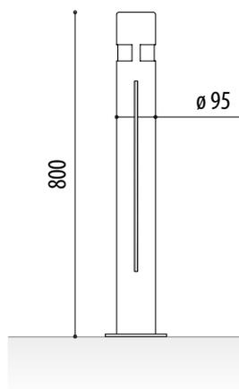
**Pilona luminosa modelo City reforzada con leds** de bajo consumo. Construida en una sola pieza evitando la rotura de la parte superior de la pilona, mediante sus dos refuerzos de hierro laterales situados justo encima del anillo de acero inoxidable.
