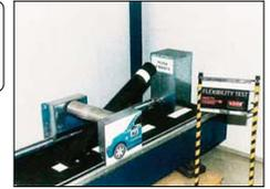
Se han realizado más de 2.000 ciclos de flexión sin que aparezca ninguna raja en la superficie de la pila y volviendo, esta a su posición original después de que le sea aplicada la fuerza necesaria para flexarla hasta los  $90^\circ$ .
