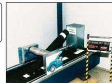
Se han realizado más de 2.000 ciclos de flexión sin que aparezca ninguna raja en la superficie de la pila y volviendo, esta a su posición original después de que le sea aplicada la fuerza necesaria para flexarla hasta los  $90^\circ$ .
