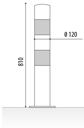
**Pilona modelo Protec** construida con tubo de hierro de diámetro de  $\varnothing$  120 mm. y 3 mm. de espesor. Placa inferior de 200x200 mm. con cuatro agujeros para fijar al suelo mediante tacos metálicos de 6 mm. de espesor con vinilo adhesivo blanco o negro según modelo. Altura total de 810 mm.
