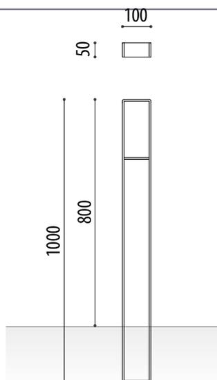
**Pilona modelo Olimpo** construida con pasamano en forma de "U" con refuerzo central. Altura total de 1000 mm.
