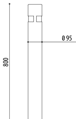
Pilona fabricada a petición de los ayuntamientos para solucionar el problema de rotura en la parte superior de las pilonas con anillo de acero inoxidable. La pilona **CITY REFORZADA**, está construida en una sola pieza incrementando así la resistencia a los impactos.
