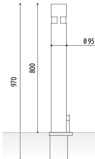
**Pilona extraíble modelo City reforzada**, creada a petición de los ayuntamientos para solucionar el problema de la rotura en la parte superior de las pilonas con anillo de acero inoxidable.
