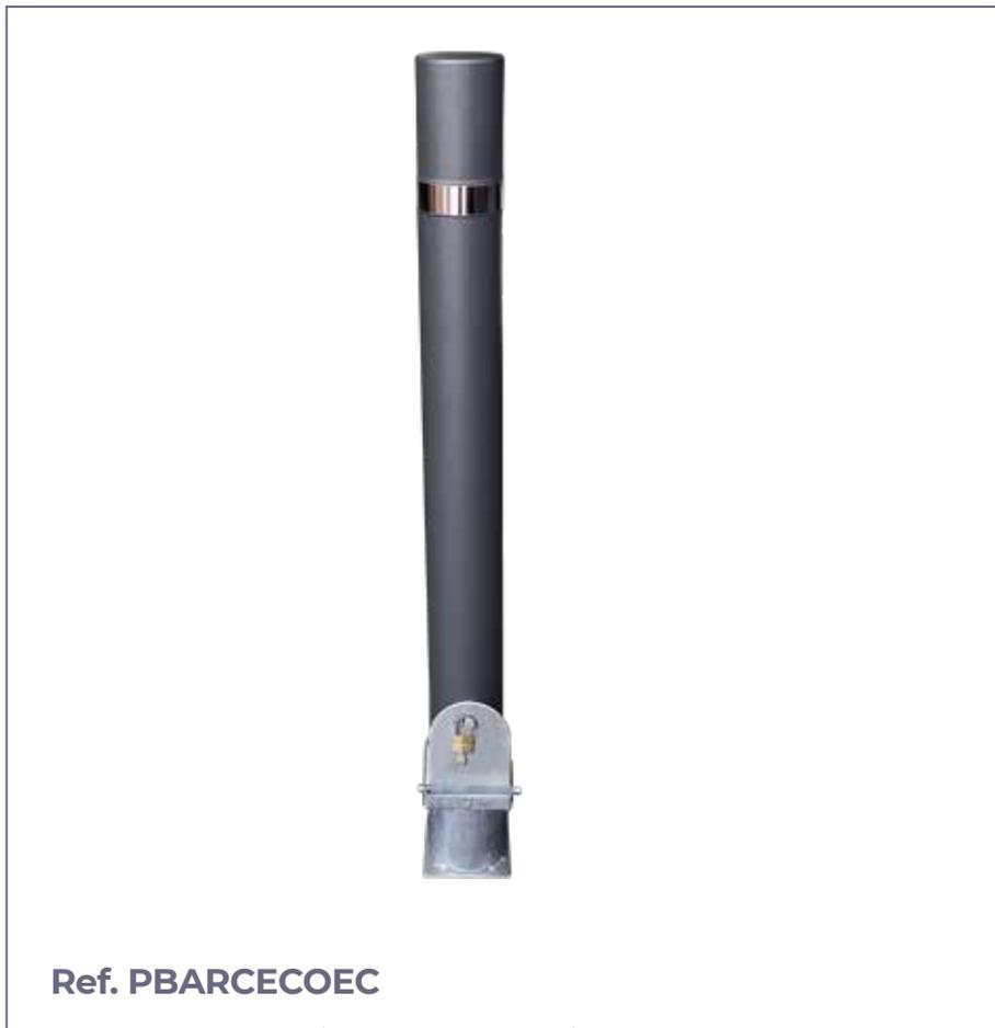
**Pilona modelo Barceco** construida con tubo de hierro de diámetro  $\varnothing 90$  y 2,0 mm. de espesor. Altura total 1000 mm. Con anillo de acero inoxidable en la parte superior. Cabeza con cantos redondeados evitando posibles daños a personas.
