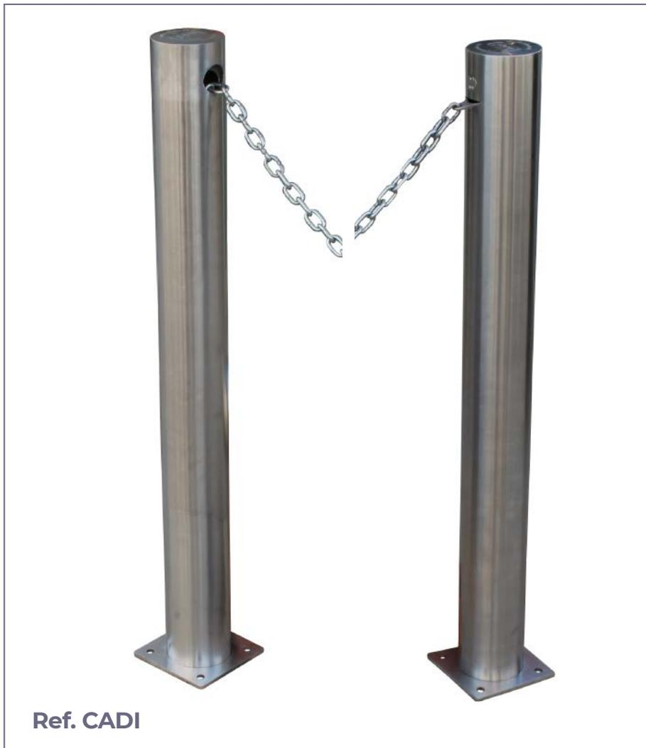
**Pilona con cadenas manual modelo Cadi** compuesta por dos pilonas en acero inoxidable de  $\varnothing$  104 ó 204 mm. (según modelo) con una cadena galvanizada alojada en el interior de una de las pilonas. Pilona con cerradura de seguridad que permite recoger la cadena en el interior de la pilona.
