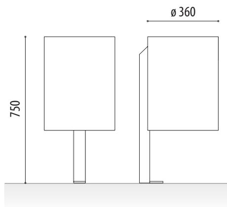
**Papelera urbana modelo Tresto** construida con chapa de acero corten de gran resistencia y robustez construida con pie rectangular de cantos redondeados y corte superior tipo flauta, placa inferior al suelo para instalar con tacos metálicos. Incluye activación corten por el exterior.
