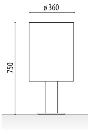
**Papelera urbana modelo Luxor** construida con chapa de acero corten de gran resistencia y robustez construida con pie central de tubo redondo y placa inferior al suelo para instalar con tacos metálicos. Incluye activación corten por el exterior.
