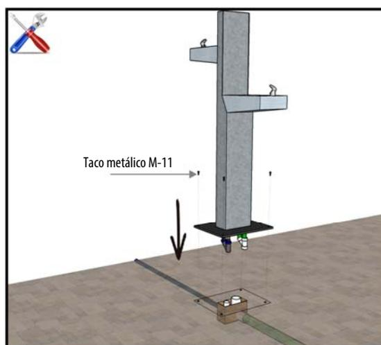
4. Conectar las uniones a la acometida de agua y desagüe existente respectivamente, colocar la fuente y fijar al suelo mediante 4 tacos metálicos M-11.
