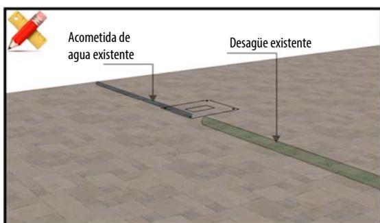
1. Efectuar el trazado según las cotas dadas en los planos de la fuente en un lugar con acceso a la acometida de agua y desagüe ya existentes.
