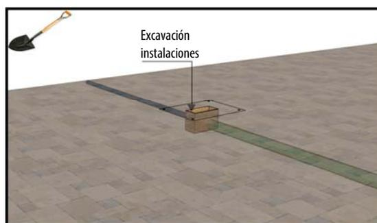
2. Realizar la excavación de la fuente a las medidas y profundidad que se requiera para realizar las conexiones de agua y desagüe.
