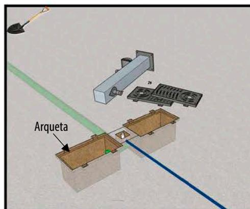
2. Realizar la excavación de las rejillas a 30mm, y de la fuente y la arqueta a las medidas que se requieran según las instalaciones de agua y desagüe existentes.
