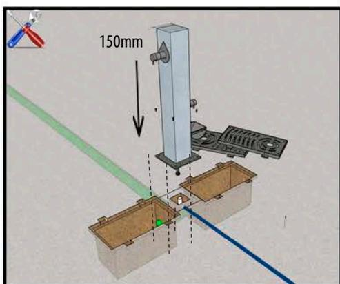
3. Conectar la toma de agua Hembra 1/2" a la acometida de agua existente, colocar la fuente y fijar al suelo mediante tacos metálicos M-11\*.
