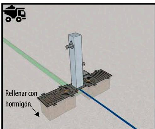
5. Rellenar los 4 agujeros de las patas de anclaje con hormigón.
