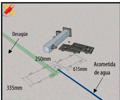
1. Efectuar el trazado según las medidas de la fuente y las rejillas en un lugar con acceso a la acometida de agua y desagüe ya existentes.
