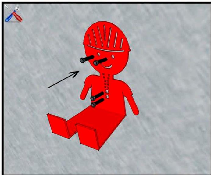
1. Colocar el muñeco con 4 tornillos M-6. Los tacos deberán de ser adecuados a la superficie donde se instalará el soporte para aguantar el peso de la bicicleta.
