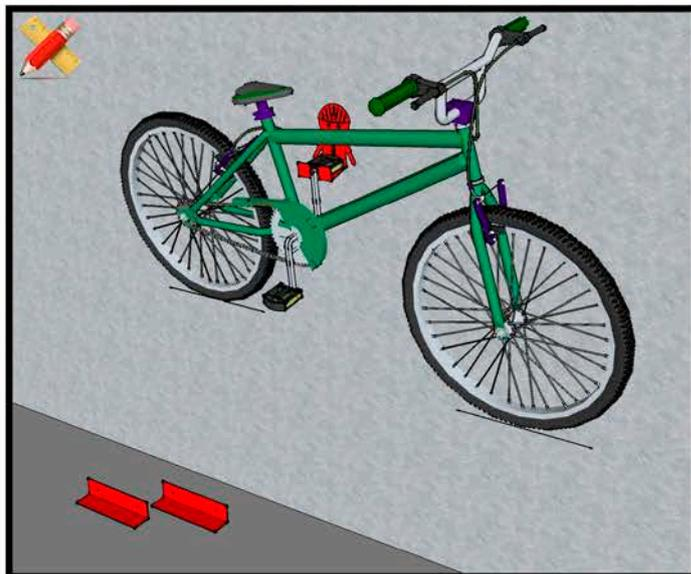
2. Una vez colgado el muñeco colgar la bicicleta y marcar la posición de la llanta delantera y trasera
