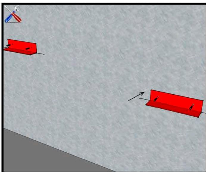
3. Descolgar la bicicleta y colocar los 2 ángulos con tornillos M-6 en las marcas colocadas anteriormente
