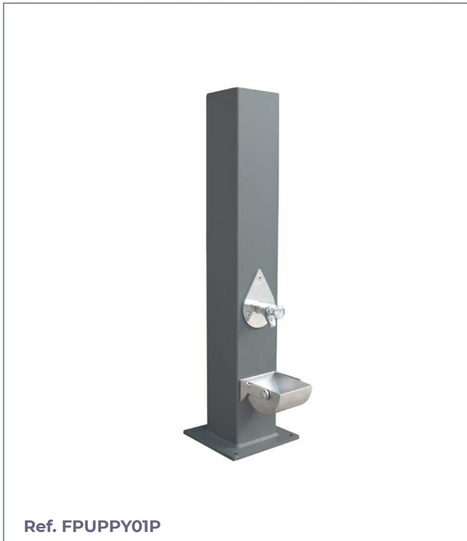
**Fuente urbana modelo Puppy** en hierro zincado más lacado al horno para una mayor resistencia a la corrosión. Grifo inferior tipo pulsador para llenado de bebedero.
