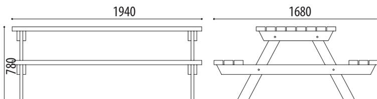
**Conjunto urbano modelo Jorvi** construido con listones de madera de pino cuperizado de 1940x93x45 mm. con tratamiento autoclave y con tornillería galvanizada.
