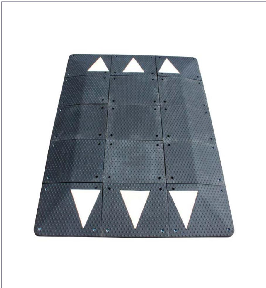
**Cojín berlinés modelo Mitte** prefabricado de caucho para vías urbanas. El cojín es una elevación implantada en medio de la calzada que constituye un obstáculo en función de la distancia de las ruedas del mismo eje del vehículo que permite a los autobuses y otros vehículos pesados no verse afectados por la misma, ya que la separación entre ruedas es más ancha que la altura del cojín berlinés.
