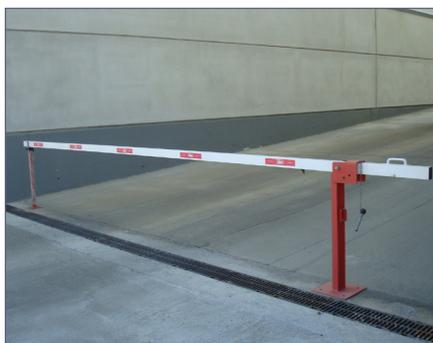
**Barrera manual modelo BM6** construida con IPN de 100 con mecanismo para alojamiento de la asta de aluminio, provisto con sistema de bloqueo mediante pasador manual para candado y con pistón de gas para facilitar la apertura y cierre de los mecanismos.
