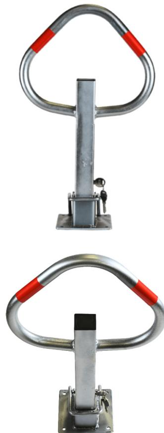
**Barrera abatible manual para plazas de aparcamiento individuales modelo Kali**, guarda parking para mantener siempre su plaza de parking reservada. Barrera fabricada con marco de tubo de acero galvanizado de Ø 50 mm. con dos bandas de señalización rojas. Bloqueo y desbloqueo mediante cerradura europea de medio cilindro.
