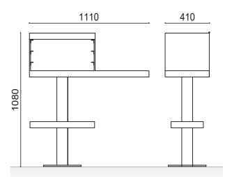
**Barbacoa urbana Grill** fabricada a partir de chapa corten con diferentes espesores. Cuerpo principal fabricado con chapa de 10 mm. y tapa abatible superior de 5 mm. Tubo de ø100x3 mm. con placa inferior cuadrada de 350x350 mm. para la fijar al suelo.
