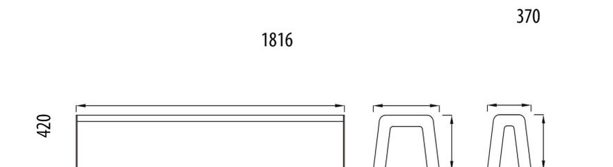
**Banqueta urbana modelo Dance** compuesta de pletina cortada por láser de 8 mm. con forma de "u" invertida con un listón metálico de 3 mm. con cantos redondeados para evitar posibles daños.
