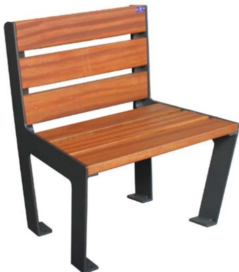
**Silla urbana modelo Poesía** compuesta de pletina cortada por láser de 8 mm. con forma de "h" con 6 listones de madera tropical de 600x110x35 mm.
