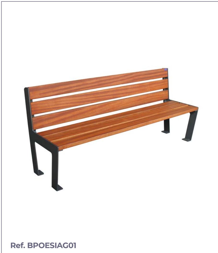
**Banco urbano modelo Poesía** compuesto de pletina cortada por láser de 8 mm. con forma de "h" con 6 listones de madera tropical de 1800x110x35 mm.
