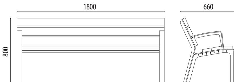
**Banco urbano modelo Nightfall** compuesto por 6 listones de madera tropical de 1800x110x35 mm. y patas de plástico reciclable de gran resistencia con tratamiento ultravioleta. Fijación al pavimento mediante tornillería.
