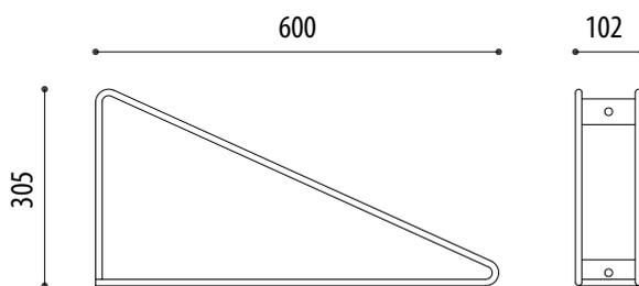
**Aparcabicicletas modelo Wall** en varilla  $\varnothing$  10 mm. de hierro negro lacado para fijar a **pared**.
