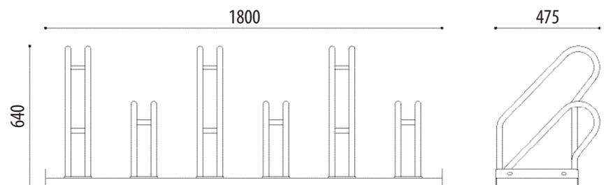
**Conjunto de aparcabicicletas modelo Modul** de hierro galvanizado en una sola pieza para estacionar 6 bicicletas intercalando parte frontal y parte trasera, construido con marco interior de medidas 375x1800 mm. de ancho.
