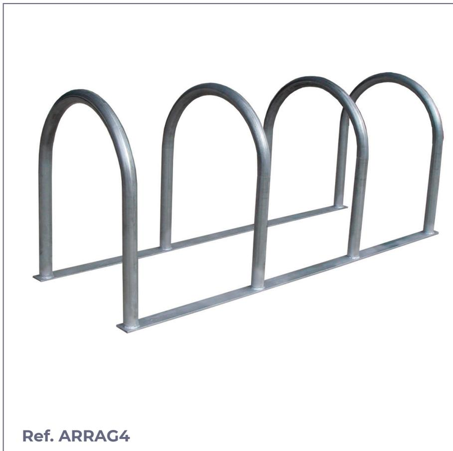
**Conjunto de aparcabicicletas modelo Arra** construido en acero galvanizado o acero inoxidable 304 o 316 con 4, 5 ó 6 separadores de tubo redondo. Pasamanos inferior longitudinal de 80x8. Varillas inferiores soldadas para su posterior colocación en obra. Instalación mediante tacos metálicos, varillas o patas para empotrar al suelo.
