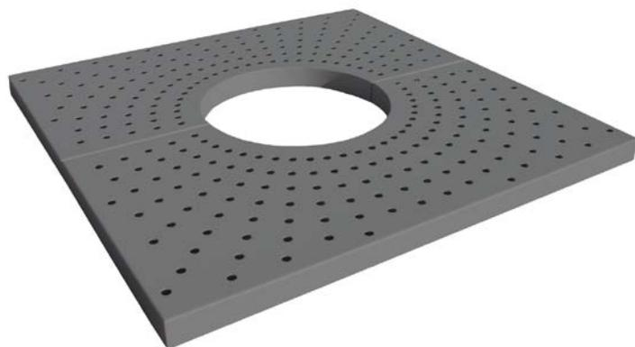
**Alcorque modelo Concéntrico** construido en 2 piezas de chapa galvanizada o corten, en forma de bandeja y reforzada con pasamanos. Incluye marco de ángulo con anclajes para fijar al pavimento.
