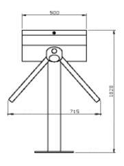
Torniquete trípode sencillo modelo Kansas para el control de entradas y salidas en instalaciones sencillas mediante un sistema mecánico o eléctrico. Estructura con dimensiones muy reducidas para poderse instalar en un espacio reducido.
