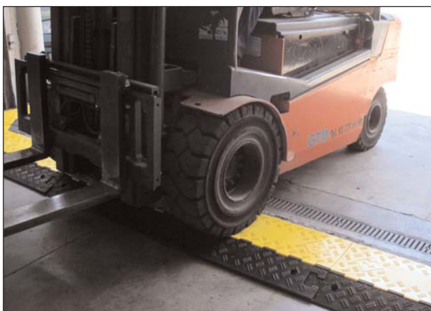
Detalle gran resistencia del protector de cables al paso de vehículos.
